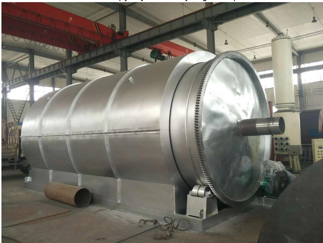
Machine de pyrolyse de recyclage des pneus
