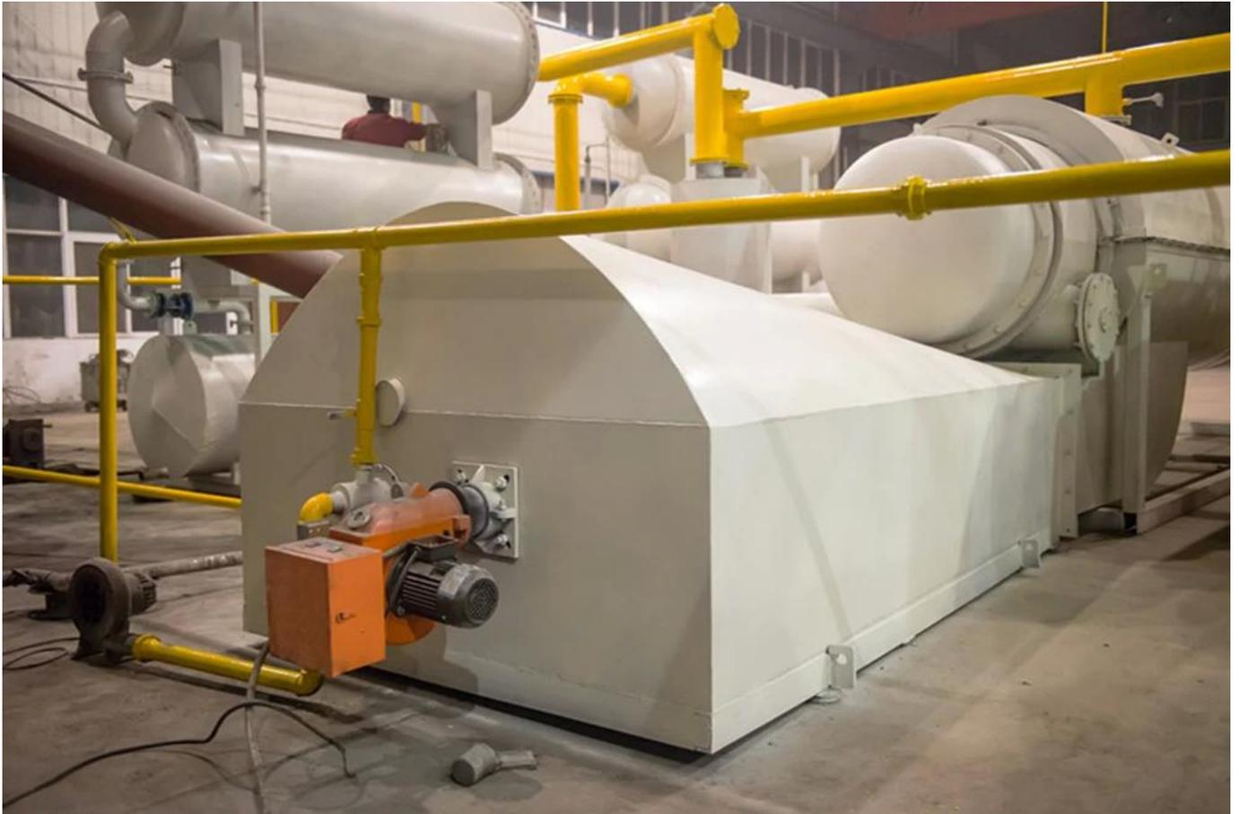
Le dernier système d'alimentation continu dans le processus de pyrolyse ne nécessite pas de redémarrage ou d'arrêt, donc il a plus de capacité de traitement. Comparé au système d'alimentation intermittent, l'automatisation puissante a le grand avantage du système de continuité, réduit les temps d'arrêt et les coûts de main-d'œuvre.
