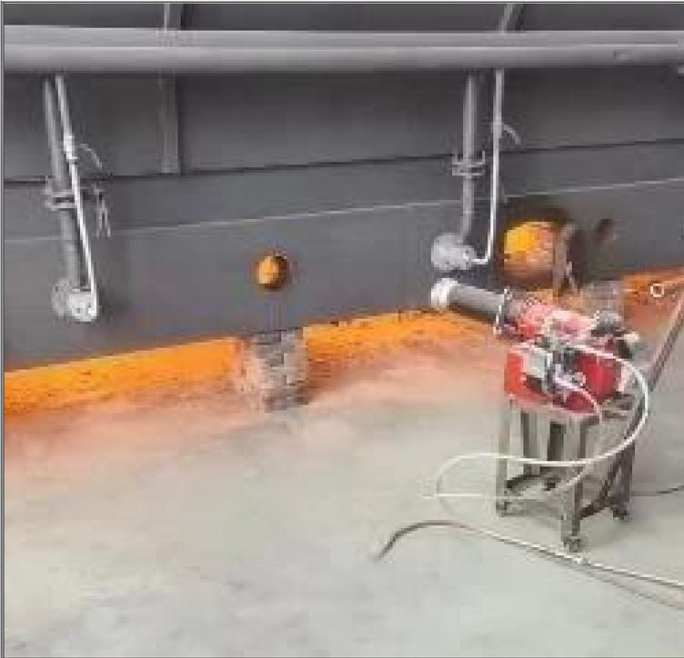
Système de recyclage des gaz combustibles non condensables recyclant en toute sécurité les gaz résiduels dans la chambre de combustion pour les brûler afin d'économiser du carburant
