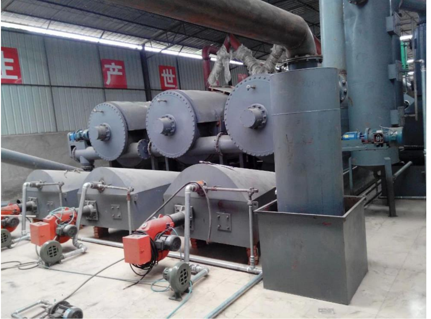
Planta totalmente continua de pirólisis de llantas de desecho.
